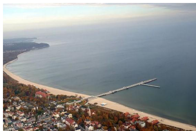
Fot. 7 | Powstała wypukłość linii brzegowej w sąsiedztwie podpór mola w Sopocie przed wybudowaniem mariny. Źródło: East News/MSF/REPORTER.
